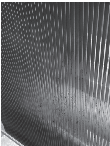
写真1 フードスライサー刃の洗浄後の状態(刃の隙間に汚れが点在していること、刃の表面の一部が汚染が堆積していることがわかる)
