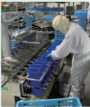
計量機洗浄後の組み立て作業
