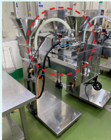
樹脂製パイプ内部は洗浄しにくく、バイオフィルム形成が疑われた
