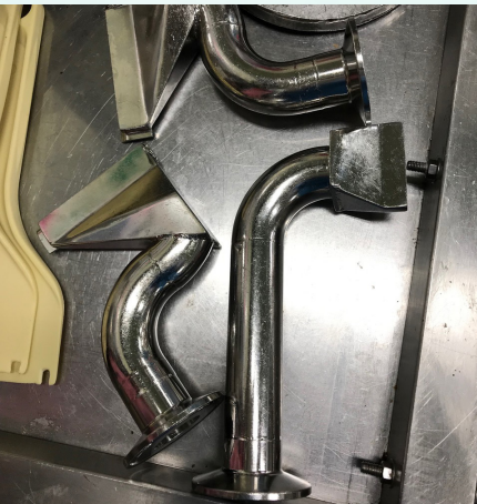
パーツ類は解体して洗浄し、作業開始前に組み立てる 作業手順に変更した
