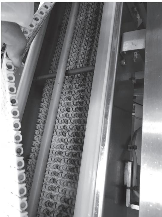
写真2 コンベア内側に堆積した汚染
